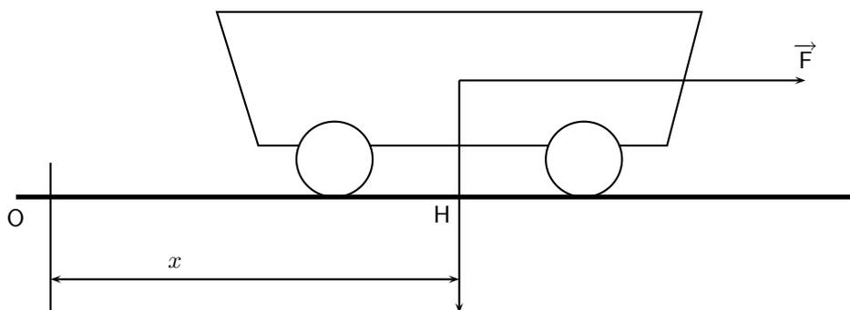
Un chariot de masse 200 kg se déplace sur une voie rectiligne et horizontale. Il est soumis à une force d'entraînement constante  $\vec{F}$  de valeur 50 N. Les forces de frottement sont proportionnelles à la vitesse et de sens contraire ; le coefficient de proportionnalité a pour valeur absolue  $25 \text{ N}\cdot\text{m}^{-1}\cdot\text{s}$ .
